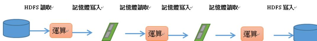
圖 2- 14 Spark in-memory 的計算框架
